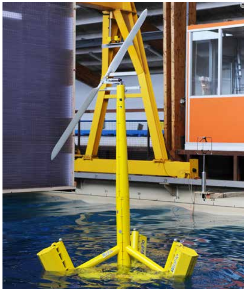
Essais de l'éolienne offshore flottante Winflo au bassin d'essais de l'Ifremer à Brest. Les partenaires de Winflo sont : NASS&WIND (Lorient), DCNS, VERGNET (Orléans), ENSTA Bretagne (Brest) et Ifremer (Brest). Lieu : Brest Année : 2011
