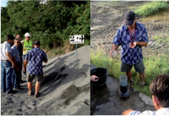
Contrôle de la qualité des matériaux par les Tests de Percolation
